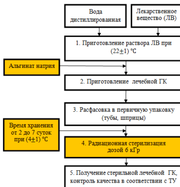
Рис.9. Схема производства лечебных гидрогелевых материалов «Колегель»
